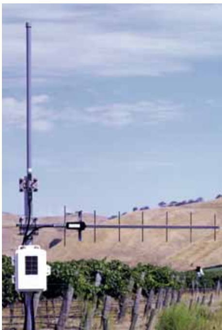
Lang-distance repeater med 1 Yagi og 1 Omni antenne
